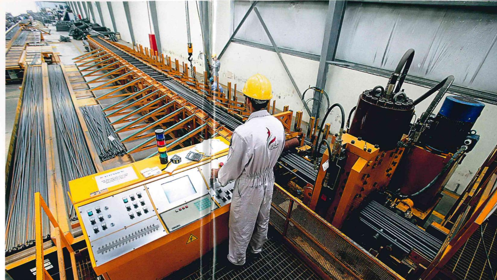
● Ligne de coupe de grande capacité, elle conjugue une grande flexibilité et une utilisation extrêmement simple. D'un côté de la piste de mesure est installé le stockage à haute capacité pour stocker le fer droit et de l'autre un banc mobile à rouleaux qui, en dehors d'alimenter automatiquement les unités de pliage, permet d'agrandir facilement à l'avenir le nombre de postes de pliage.
